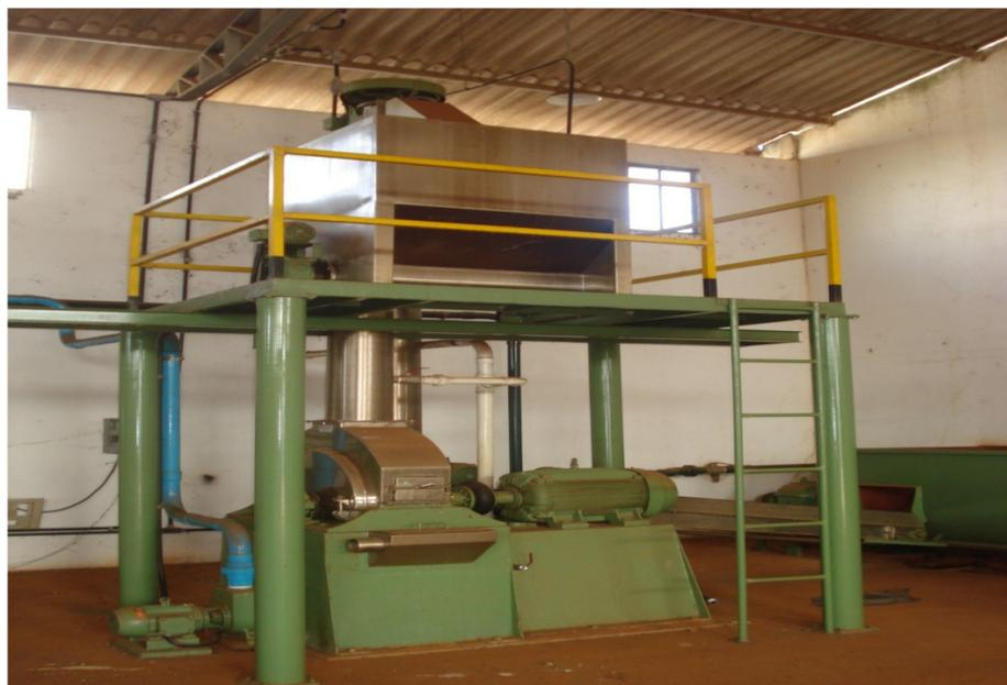
**DESINTEGRADOR CEVADEIRA+ALIMENTADOR TOSADOR, equipado com motor JHM de 60 cv
