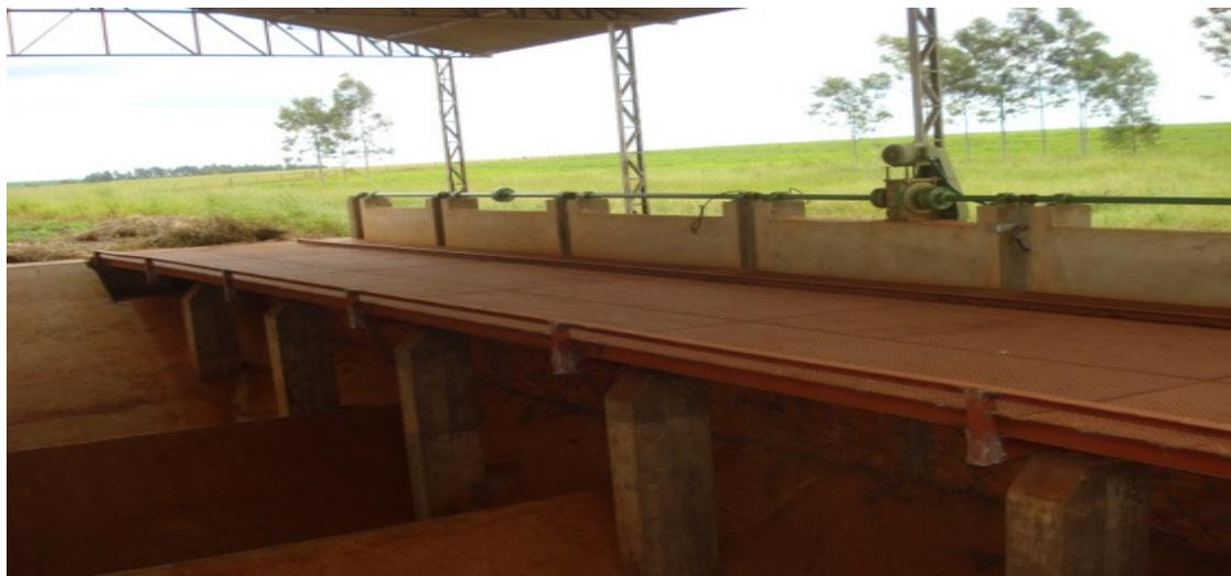
**RAMPA DE DESCARGA DE RAÍZES, equipada com motor Kolback 10 cv
