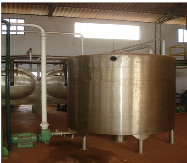
**TANQUE, Reservatório de líquido para controle de fluxo de produção, equipado com moto-bomba Kolbch de 7,5 cv R\$ 17.075,00**
