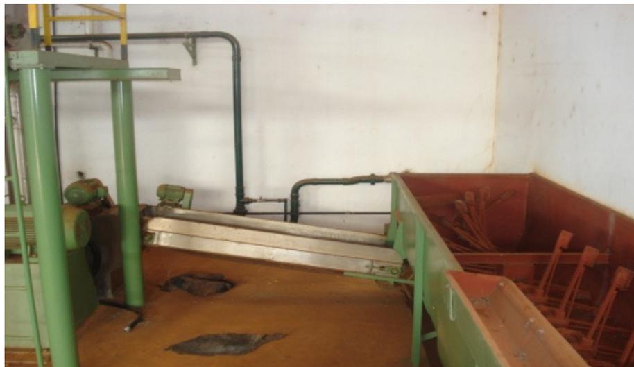
**CORREIA DE INSPEÇÃO**, equipada com motor Kolbach de 02 CV
