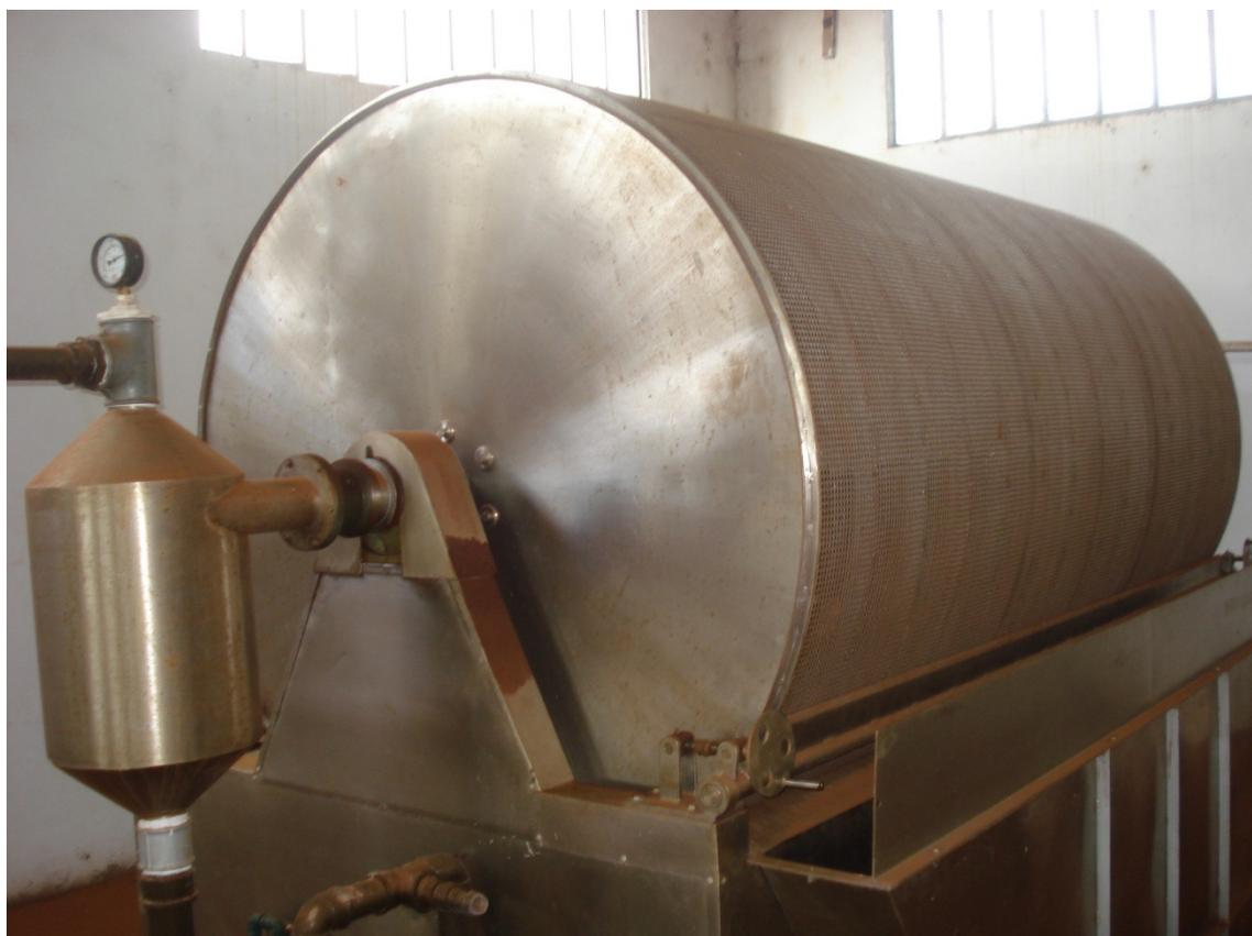
**DESIDRATADOR CENTRIFUGO EBS DC 1500, equipado com motores: Erbely 05 cv; Sew 02 cv e Weg 7,5 cv
