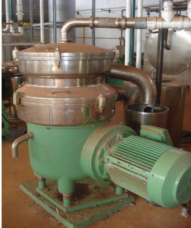
**CENTRIFUGA EBS CT-100 PRIMARIA+COLETOR INOX+MOTOBOMBA INOX, equipado com motor Weg 100 cv
