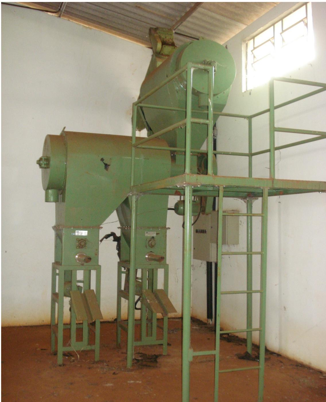
**CLASSIFICADOR DE AMIDO SECO 5 TON/H + ROSCA ALIMENTADORA + ROSCA P/ENSAQUE +
