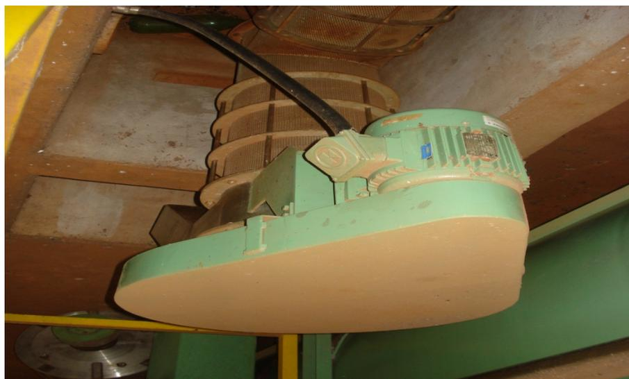
**ROSCA DUPLA DE CASQUINHA+MOTOBOMBA SEMI SUBMERSA, equipada com 02 (duas) moto bombas Kolbach de 02 CV
