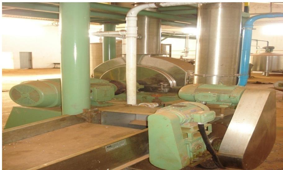
**TRITURADOR DE RAÍZES+ROSCA INOX ELEVATORIA**, equipado com motor Weg de 15 cv
