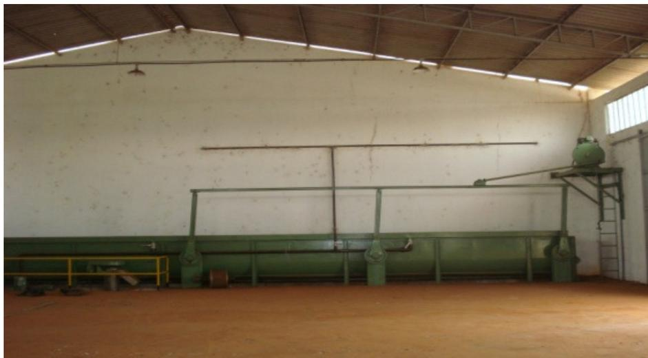
**LAVADOR DE RAÍZES, equipado com 03 (três) motores Kolbach, sendo BP-7605 de 02 cv; BP-7606 de 02 cv e BP-7607 de 7,5 cv
